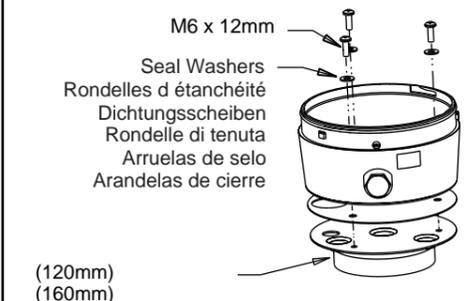
If using conduit, assemble conduit hub to conduit first, then attach to base.
